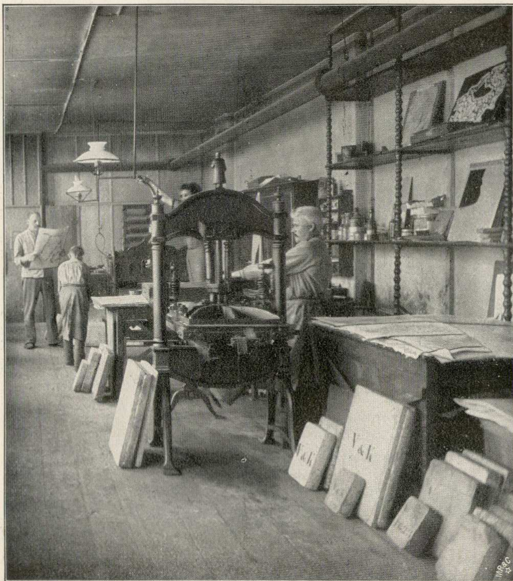
Die Herstellung von Druckproben vermittels der Handpresse.
