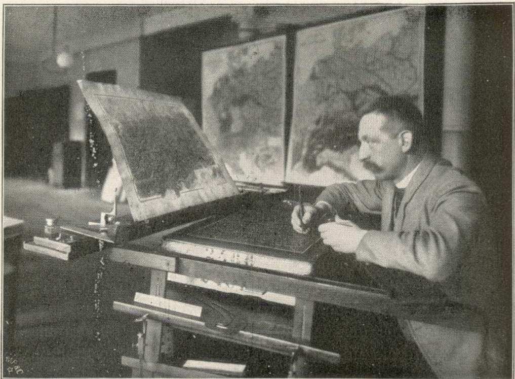
Der Stecher (Lithograph) beim Gravieren einer Gebirgskarte.
